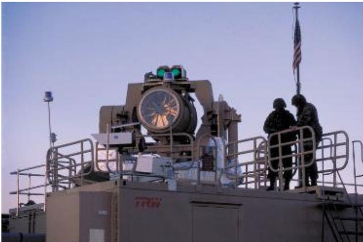
Ainsi, le laser tactique à haute énergie israélo-américain (*Tactical High Energy Laser - THEL*) a intercepté avec succès un missile test en juin 2000, test réitéré avec succès en septembre 2000. Les États-Unis construisent actuellement un prototype de laser aéroporté qui consiste en un laser de grande puissance monté sur un Boeing 747. Le premier test contre un missile balistique est prévu pour cette année. Le département de la Défense des
